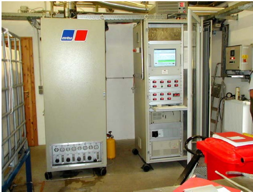
Testovací panel palivového článku č.1 v Seabornes, Německo
