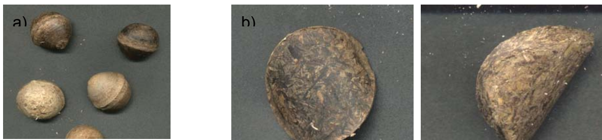
Obr. 5 Nové tvary výliskov [4], [5]. a) guľový výlisk, b) prienik dvoch valcov
